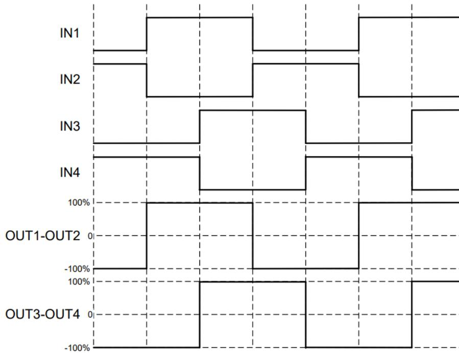
**Figure 2-9. Full-Step Sequence Waveforms**
