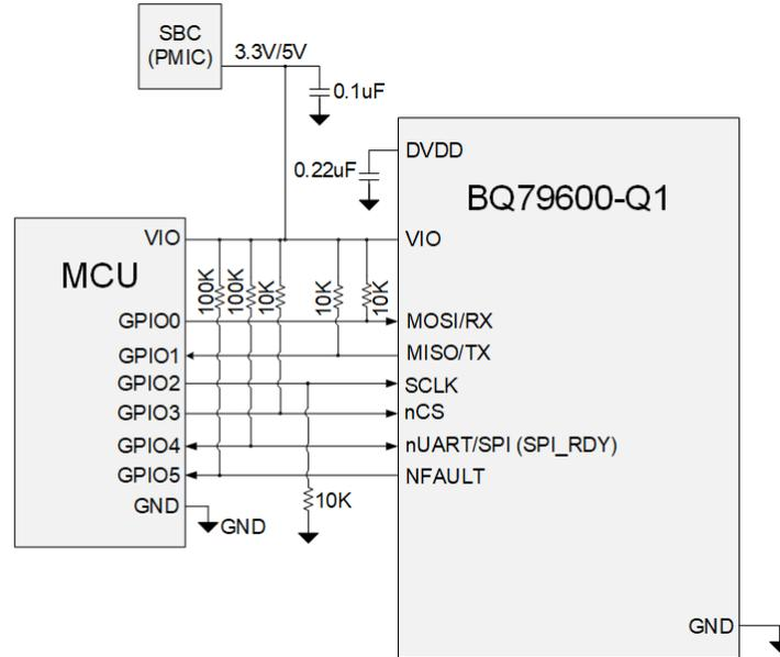
**Figure 1-4. SPI Interface Used**
