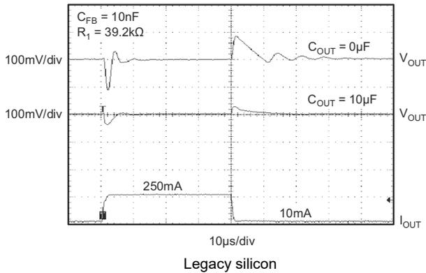
**Figure 5-51. TPS73201-Q1 – Load Transient, Adjustable Version**
