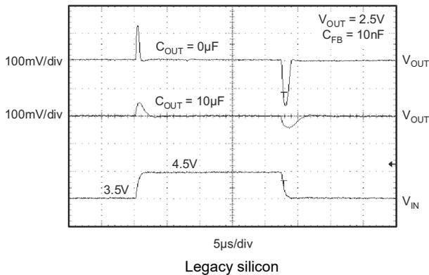
**Figure 5-53. TPS73201-Q1 – Line Transient, Adjustable Version**
