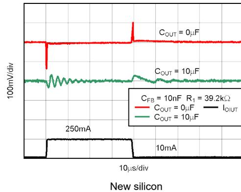
**Figure 5-52. TPS73201-Q1 Load Transient, Adjustable Version**
