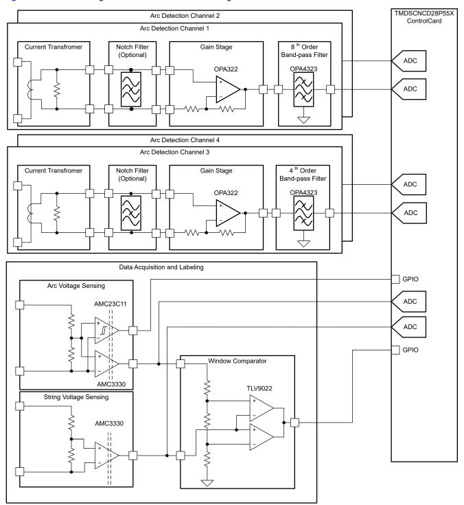
Figure 2-1. TIDA-010955 Block Diagram
