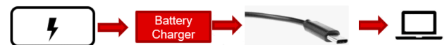
圖 6. 使用相同的 USB Type-C® 線從可攜式充電器電池放電，並以 140 W 功率為筆記型電腦充電。
